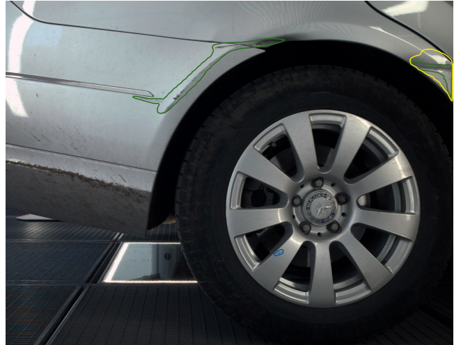
Bild 4. Am Fahrzeug werden von der automatischen Schadenserkennung ein Felgenschaden (blau), eine Verformung (gelb) und Kratzer (grün) erkannt. Im Bereich der Stoßstange sind auch Verschmutzungen zu erkennen, die richtigerweise nicht als Fehlstellen erkannt werden. © Fraunhofer IPA
