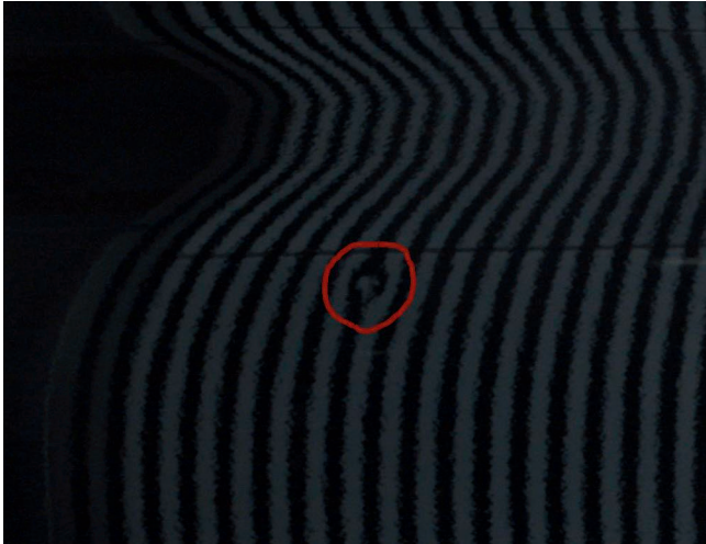
Bild 3. Dellen erzeugen eine charakteristische Verzerrung der Streifenbeleuchtung und können somit indirekt detektiert werden. © Fraunhofer IPA
